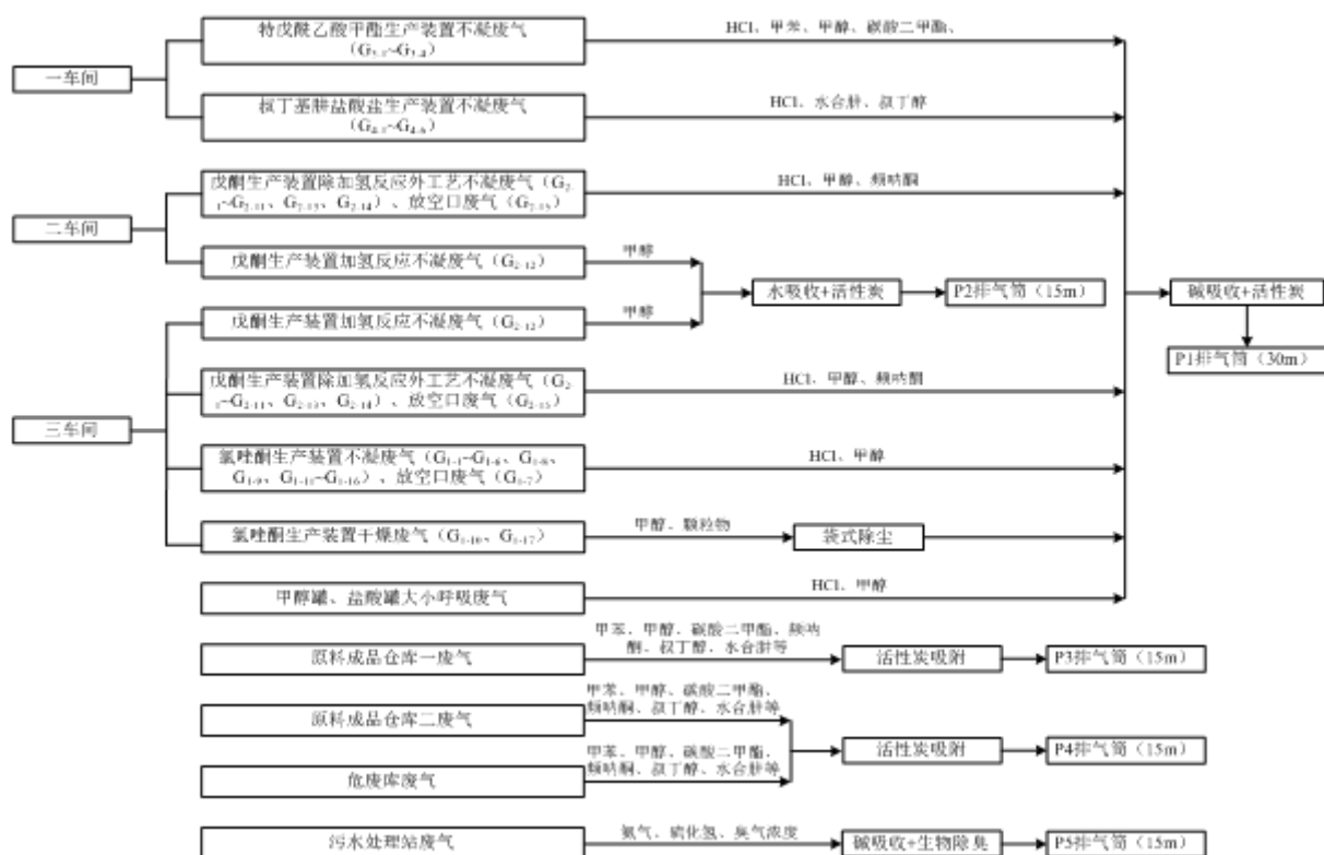
图 3.4-27 拟建项目废气处理走向图
