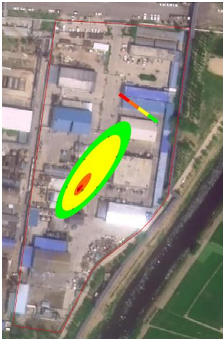
图 5-16 长期泄漏 1000d, COD 在地下水中污染范围示意图
