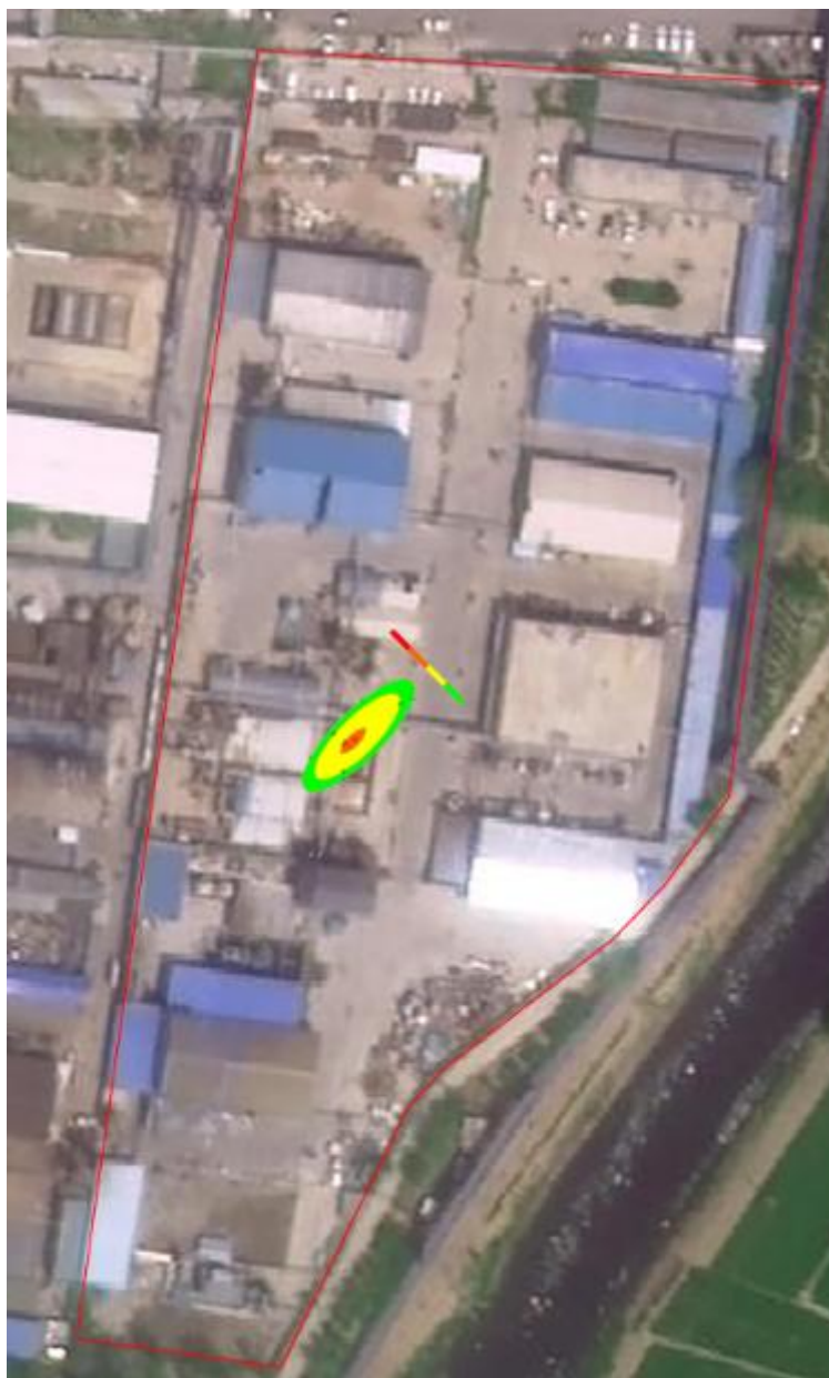
图 5-15 长期泄漏 100d, COD 在地下水中污染范围示意图
