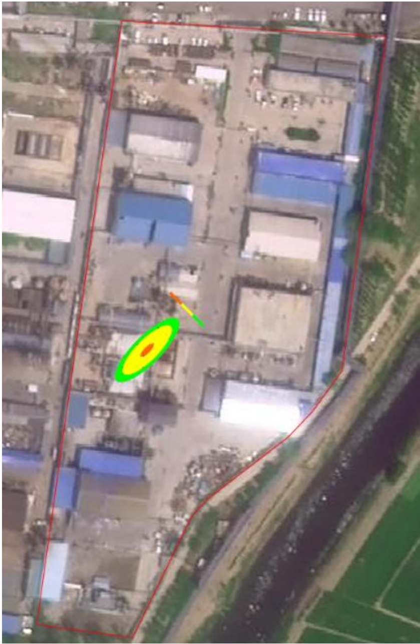
图 5-18 瞬时泄漏 100 天后 COD 污染范围示意图
