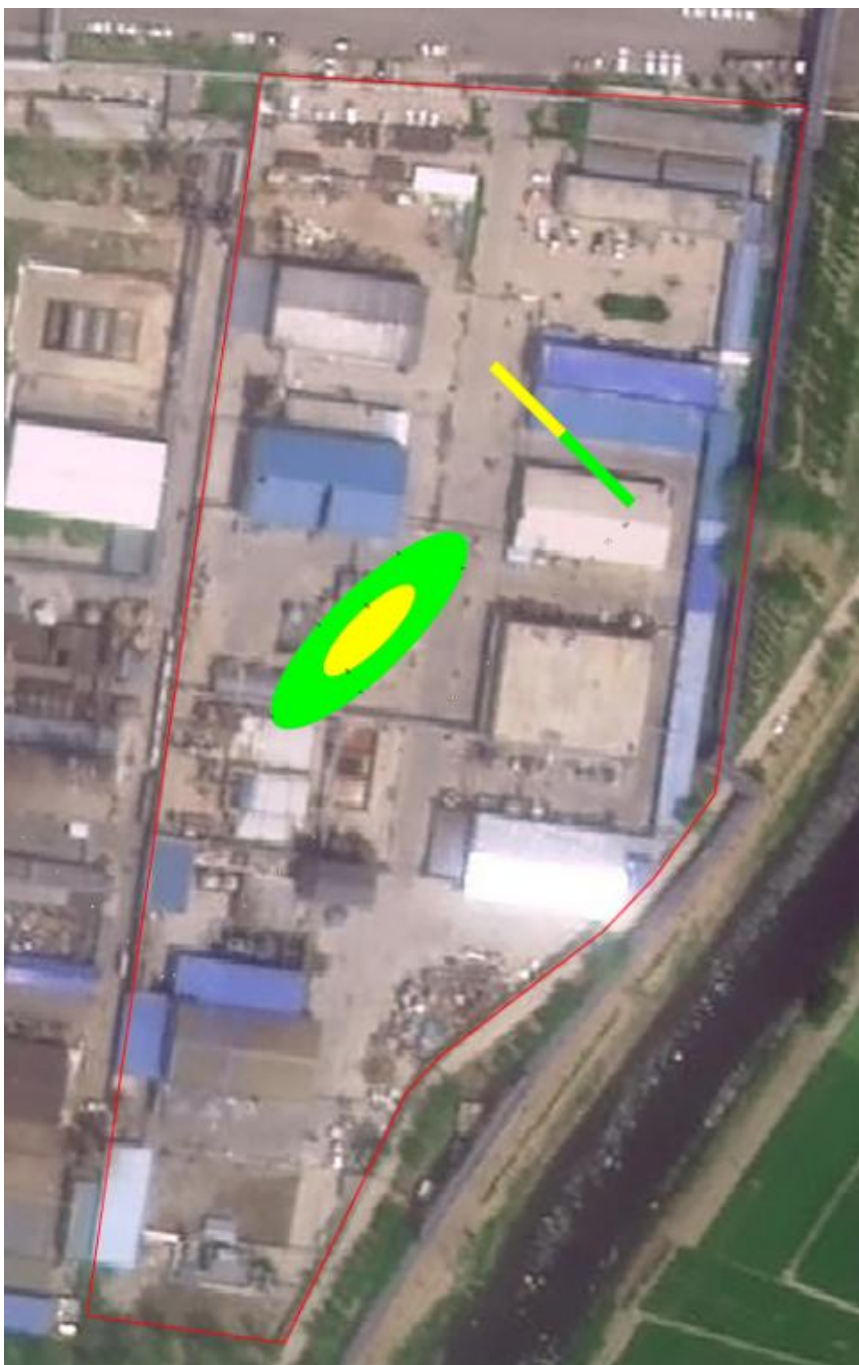
图 5-19 瞬时泄漏 1000 天后 COD 污染范围示意图
