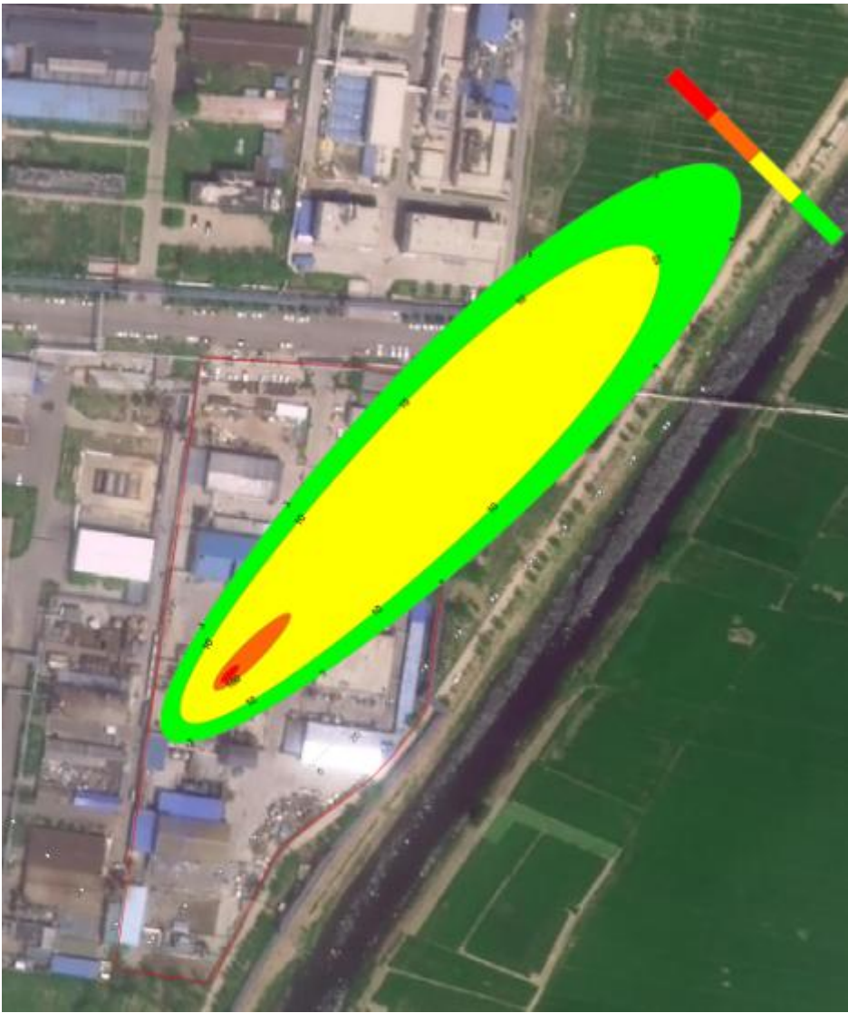
图 5-17 长期泄漏 7300d，COD 在地下水中污染范围示意图
